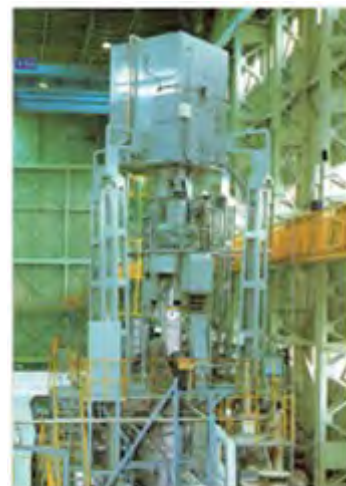
大型ポンプのナトリウム中試験
