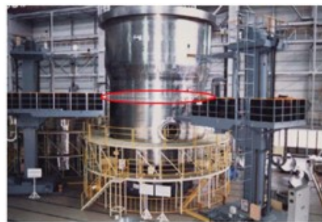
大型部材の高品質溶接
